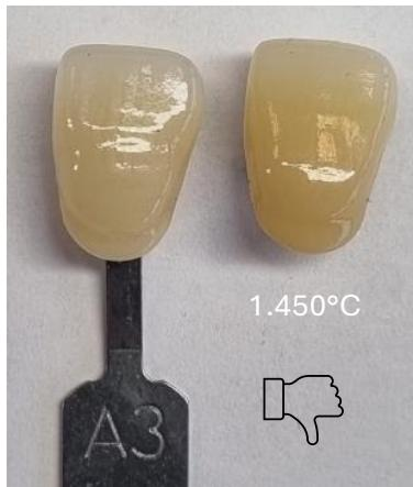
Bei zu geringer Temperatur ist die Farbe chromatisch übersteuert (gelb- braun Dominanz). Bei monolithischen Konstruktionen wird der Effekt jeweils nach der Glasur deutlich verstärkt. ←Bild links, ↓Bild unten
